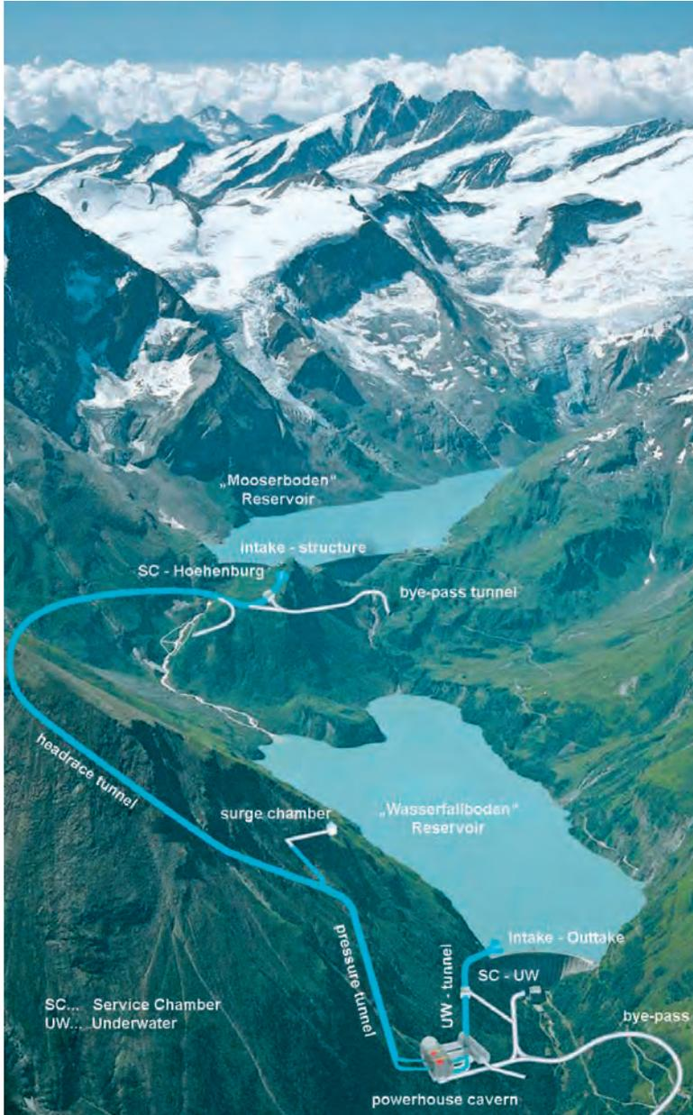
Limberg II dient als Ausgleichs- und Regelkraftwerk im Falle eines Ungleichgewichts zwischen Stromerzeugung und Stromverbrauch.
