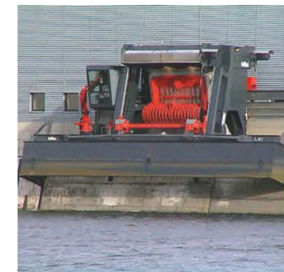
Dammbalken setzen mit Seil - Rechenreinigungsmaschine
