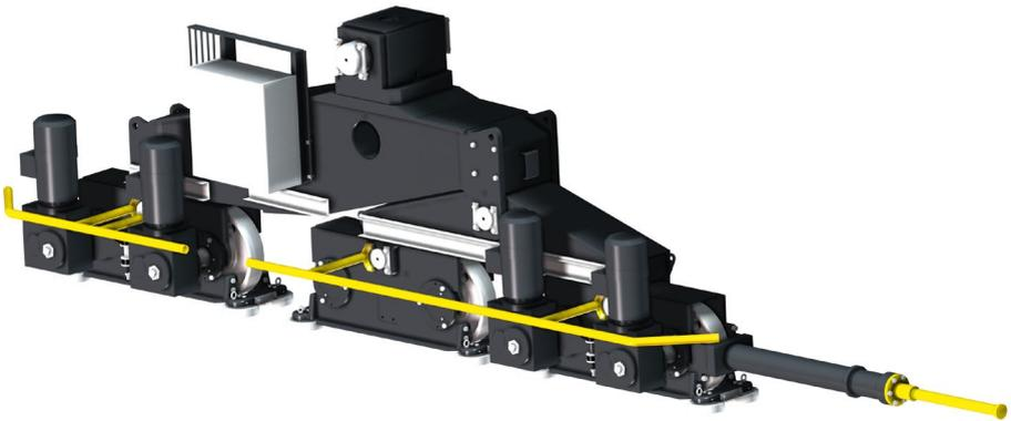
Die bestehenden Fahrwerke können schnell und effizient mit den vormontierten Fahrwerken ersetzt werden. Der Einbau von modularen Umrüstpaketen durch unsere qualifizierten Techniker erlaubt es uns Umbauzeiten auf ein Minimum zu reduzieren.
